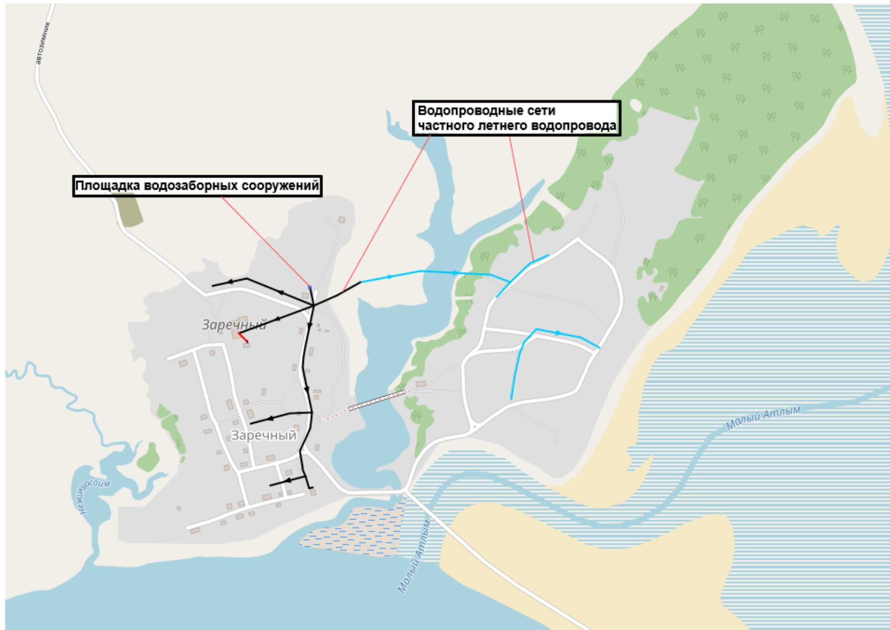
Рисунок 1.1.1.3 – Картосхема зоны действия ТЗ ВС п. Заречный и расположения входящих в нее объектов ЦС ХВС
