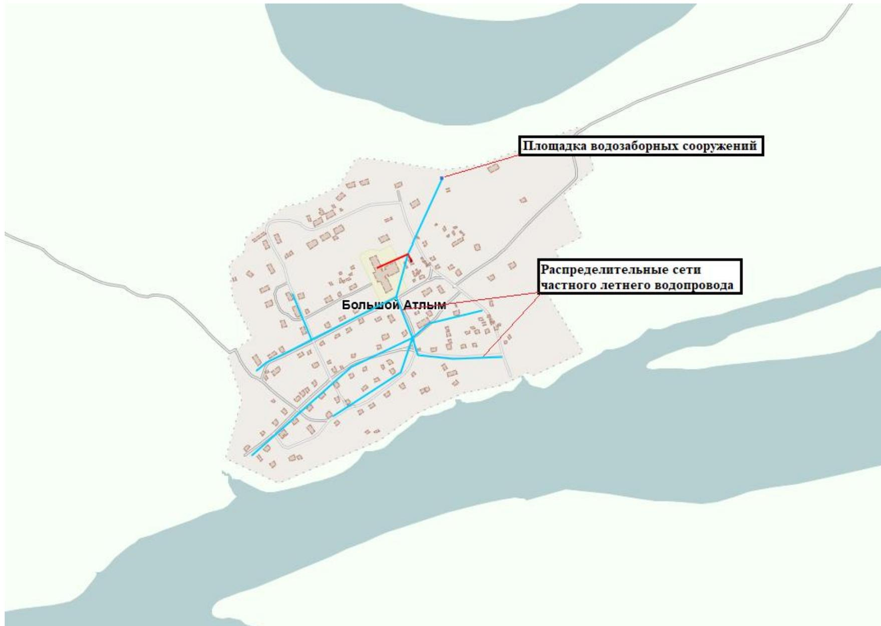
Рисунок 1.1.1.2 – Картограмма зоны действия ТЗ ВС с. Большой Атлым и расположения входящих в нее объектов ЦС ХВС
